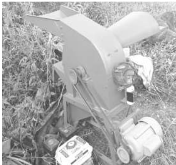
Gambar 5. Mesin pencacah sampah biomassa hasil rancangan.
