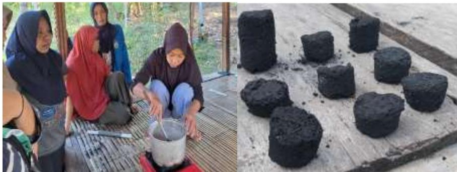
Gambar 4. Proses pembuatan adonan tepung terigu yang berfungsi sebagai perekat. Proses pencampuran adonan dengan bubuk arang sekaligus pencetakan briket
